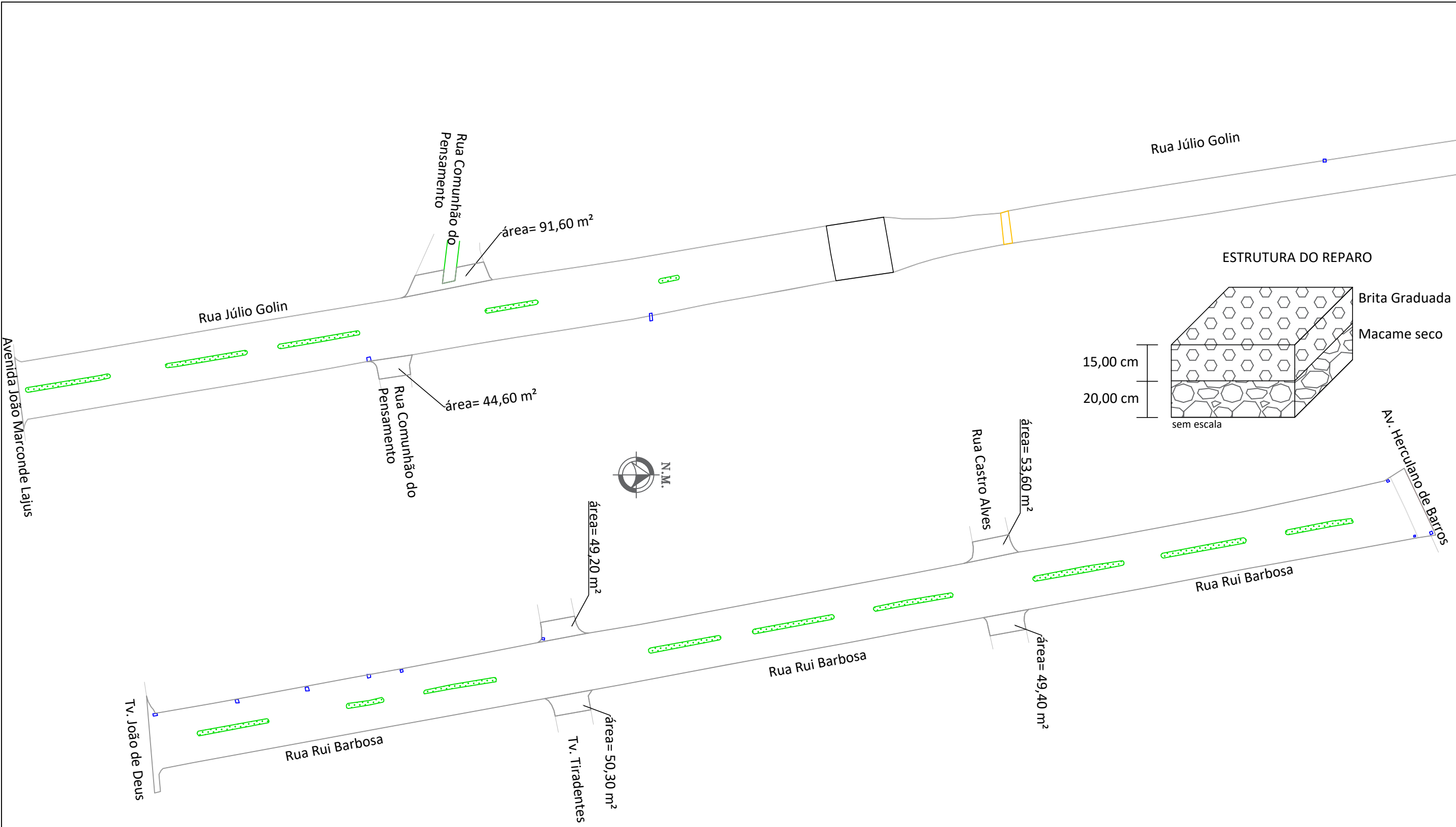
PLANTA BAIXA - GEOMÉTRICO E REPAROS ESCALA : 1/1000
